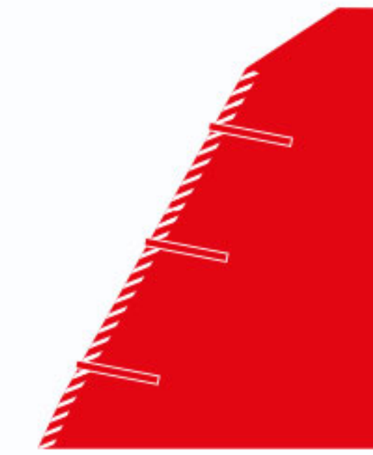
Böschung- und Felssicherung durch Spritzbeton
